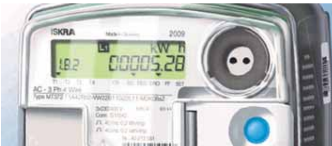
Abb.1 „Intelligenter“ Zähler der Firma Iskraemeco
